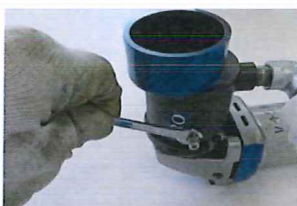
コンビネーションスパナで、 カバー固定用ナットを締めます
