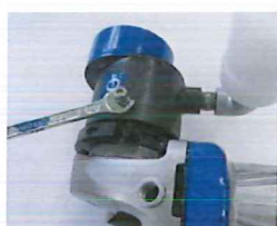
コンビネーションスパナで カバー固定用ナットを緩めます
