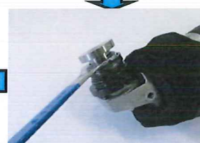
専用研削刃を取り付け、 スパナでしっかりと固定します
