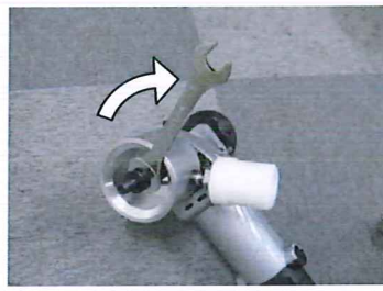
②スパナで取付軸を締め付けます
