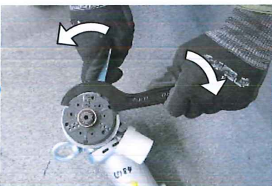
④スパナ及びフックスパナで取付軸に締め付けます
