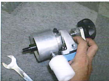
①本体の回転止めを押した状態で取付軸をねじ込みます
