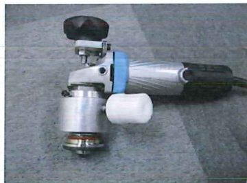
②スパナで取付軸を締め付けます
