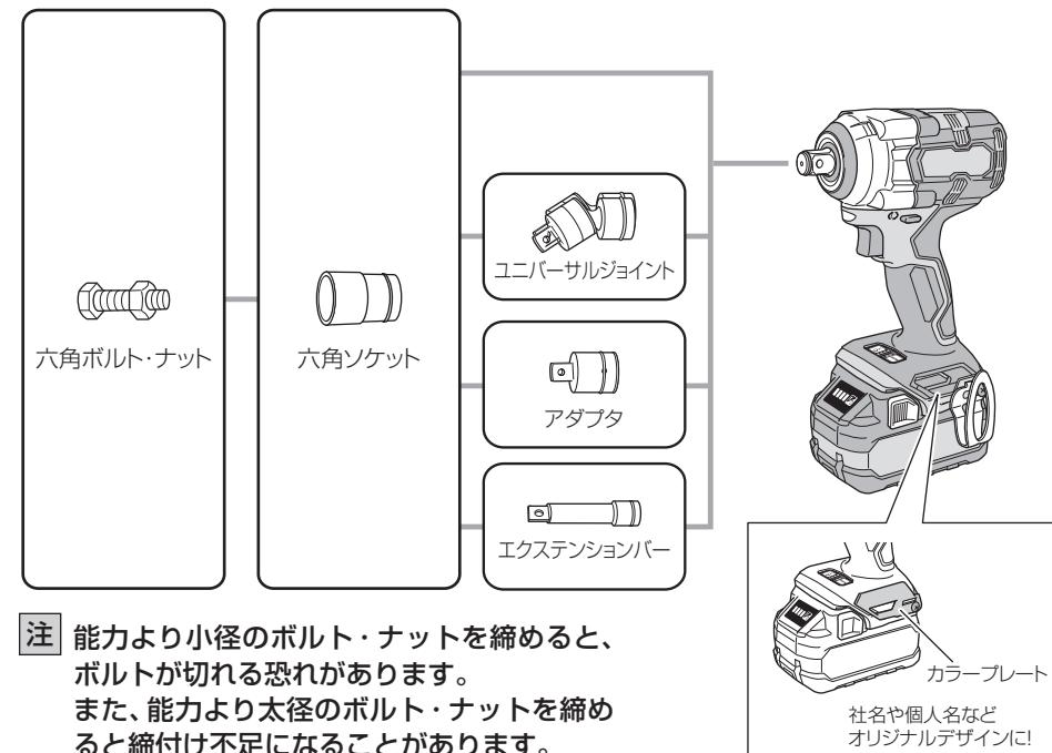
**注** 能力より小径のボルト・ナットを締めると、
