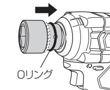
注 •Oリングをソケットの溝からずらすとき、ピンを落としてなくさないようにしてください。
