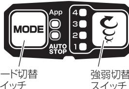
注 締付けモードの切り替えは、スイッチを入れてない状態で行ってください。故障の原因になります。
