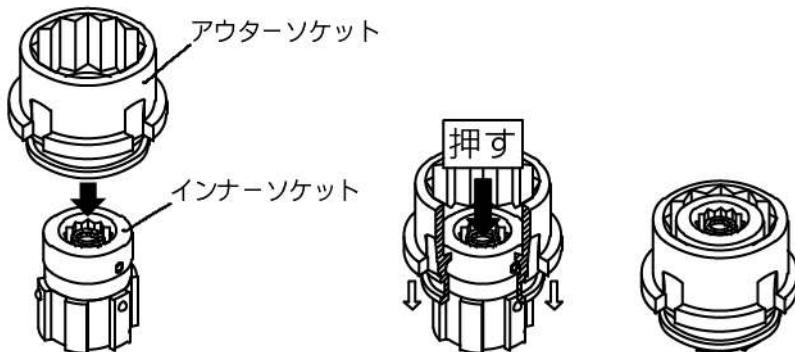
○インナーソケットスプリングが電動レンチに正常にセットされているか、確認してください。次に、アウターソケットとインナーソケットをセットした状態で、アウターソケットの凹凸部を本体のアウターソケットホルダの凹凸部の位置に合わせて差し込みます。
