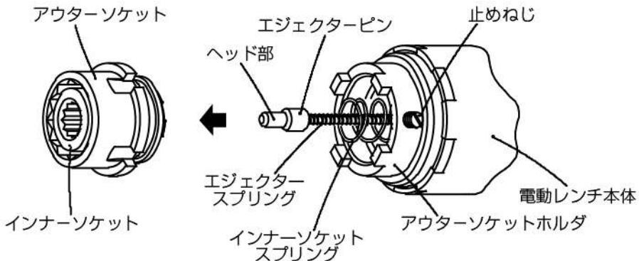
○アウターソケットからインナーソケットを外す場合は、突き出しピンを付属の（一）ドライバー、またはボルトのピンテールで押すと外れます。
