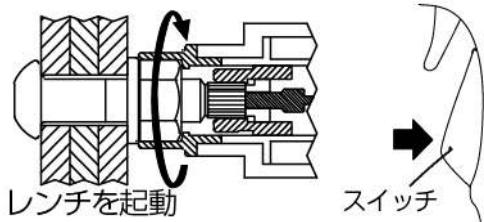
○締付けが進むと回転スピードが徐々に遅くなり、規定トルクに達すると、ボルトの破断溝部でピンテールが切斷されます。
