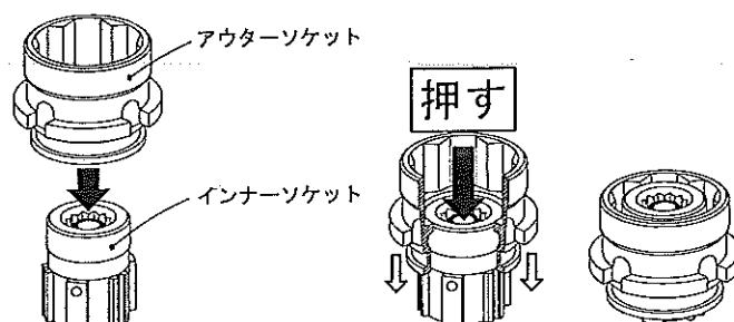
○インナーソケットスプリングがコードレスレンチに正常にセットされているか、確認してください。次に、アウターソケットとインナーソケットをセットした状態で、アウターソケットの凹凸部を本体のアウターソケットホルダの凹凸部の位置に合わせて差し込みます。
