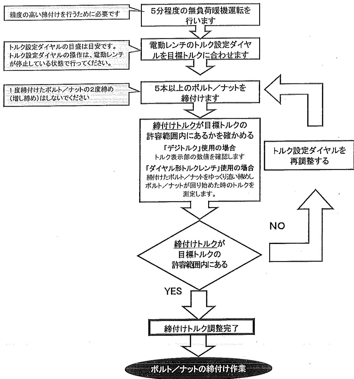
○締付けトルクは、ボルト／ナットの表面の状況、電源、延長コードなど、締付け条件の変化により変動します。トルク設定ダイヤルの設定は毎日の作業開始時と締付け条件が変化した時に行ってください。
