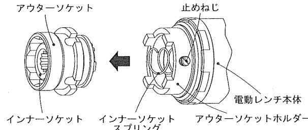
○アウターソケットからインナーソケットを外す場合は、突き出しピンを押すと外れます。
