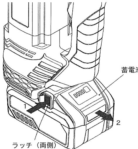
○蓄電池を取り付けるときは逆の要領で、レンチ本体の溝に合わせ、奥まで挿入してください。この際に、「カチッ」と音がするまで、奥まで確実に挿入してください。
