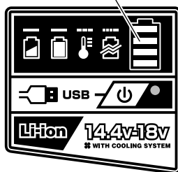
電池容量ランプ
