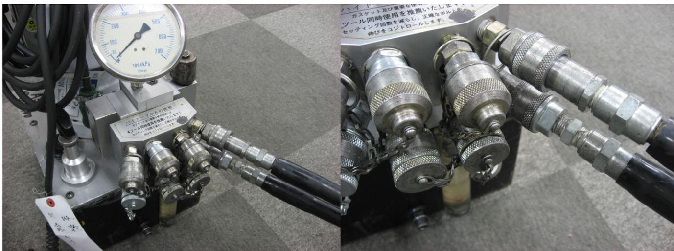
取り付け説明: 上下のカプラで1組となります。写真の様に上下カプラへホースを差し込む。
