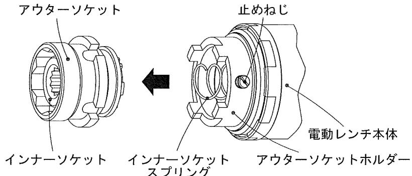
○アウターソケットからインナーソケットを外す場合は、突き出しピンを付属の(ー)ドライバー、またはボルトのピンテールで押すと外れます。
