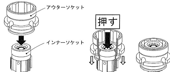
○インナーソケットスプリングが電動レンチに正常にセットされているか、確認してください。次に、アウターソケットとインナーソケットをセットした状態で、アウターソケットの凹凸部を本体のアウターソケットホルダの凹凸部の位置に合わせて差し込みます。
